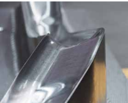
Beispielwerkzeug: Hohe Genauigkeiten bis zu 5 µm sind bei Dast keine Seltenheit. Hier im Bild ist das Detail eines IHU-Werkzeugs zu sehen. (© Hanser/Schröder)
